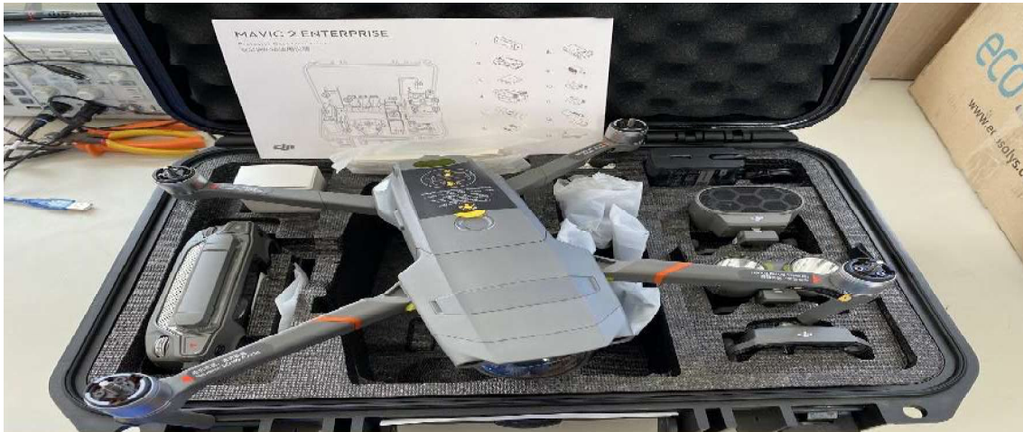
Fig. 6 Drone com câmera termográfica do LEFEER
