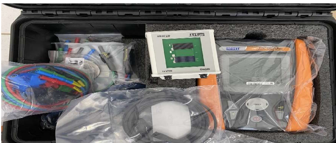
Fig. 5 Traçador de curva I-V do LEFEER
